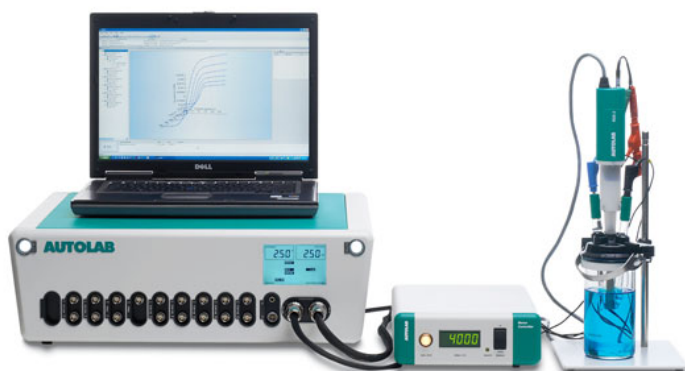
オートラボ PGSTAT302N 電流最大 +2A (±20A ブースターオプション) 電圧最大 ±30V
