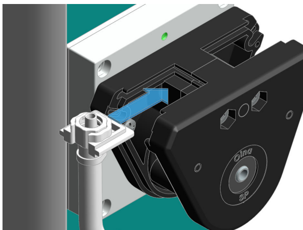
図 39 ポンプチューブの挿入
