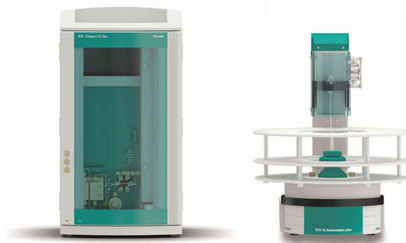
Abbildung 1. Instrumentelle Einrichtung mit einem 930 Compact IC Flex Oven/Deg und einem 919 IC Autosampler plus.
