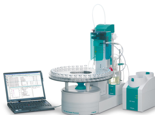
Abbildung 1. Vollautomatisches System bestehend aus einem 874 Oven Sample Processor mit 851 Titrand für die coulometrische Karl-Fischer-Analyse nach Verdampfung der in der Probe vorhandenen Feuchtigkeit.
