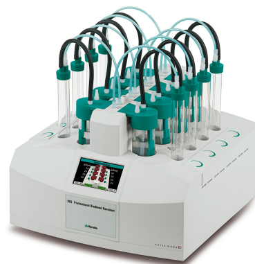
Abbildung 1. 893 Professional Biodiesel Rancimat, ausgestattet mit Mess- und Reaktionsgefäßen zur Bestimmung der Oxidationsstabilität von Biodiesel und dessen Mischungen.
