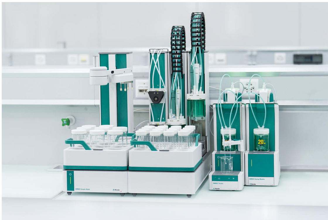
Abbildung 1 OMNIS Probenroboter S ausgestattet mit OMNIS Titrator, Dosiermodul und dUnitrode Elektrode zur automatisierten Bestimmung von Pyrophosphat in wässrigen Proben.
