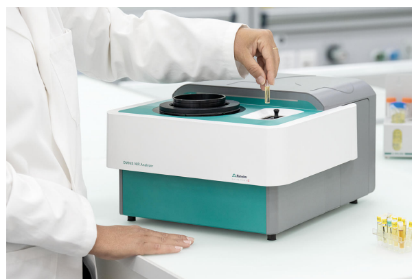
Abbildung 1. Der OMNIS NIR Analyzer und eine in ein Einwegvial gefüllte Probe.
