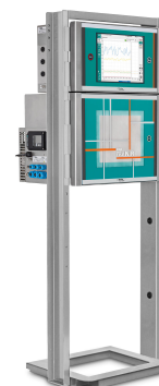
Abbildung 2. Der 2060 The NIR-Ex Analyzer von Metrohm Process Analytics kann %NCO im PU-Produktionsprozess nahezu in Echtzeit messen.
