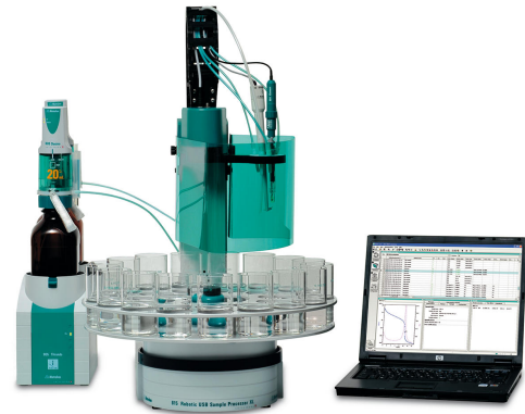
Abbildung 1. Titrande-System bestehend aus einem 815 Robotic USB Sample Processor XL in Kombination mit einem 907 Titrande.
