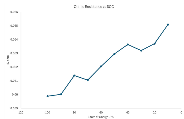
Abbildung 5. Ohmscher (serieller) Widerstand im Vergleich zum SOC der Batterie.
