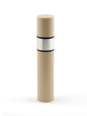
Abbildung 1 Rotierende Zylinderelektrode mit Metalleinsatz, O-Ringe aus Viton (schwarz) und PEEK-Halter.
