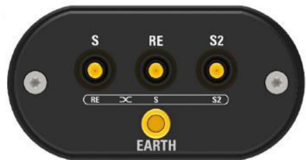
Abbildung 2. Hier ist die Buffer Box (Teil der Pure Signal Bridge) mit den Anschlüssen für die Erdung (EARTH) und für die adaptiven Kabeln der Sense (S), Referenz (RE) und zweiten Sense (S2) abgebildet.
