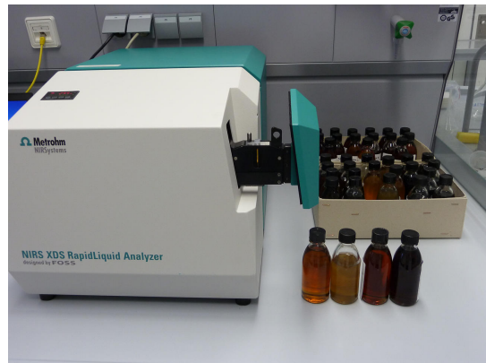
Abbildung 1. XDS RapidLiquid Analyzer und Schmierstoffproben.
