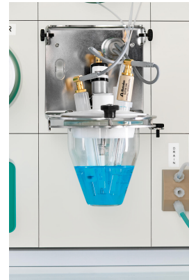
Abbildung 3. Nahaufnahme der elektrochemischen Zelle im 2060 CVS Process Analyzer.
