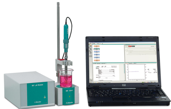
Abbildung 1. 867 pH-Modul, gesteuert durch die tiamo-Software zur Durchführung der Standardaddition.
