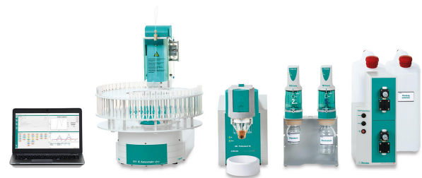
Abbildung 1. 884 Professional VA, vollautomatisch für voltammetrische Analysen.
