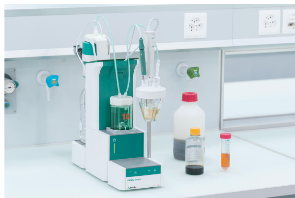
Abbildung 1. OMNIS Titrator Professional, ausgestattet mit einer dThermosonde und einem Stabrührer.
