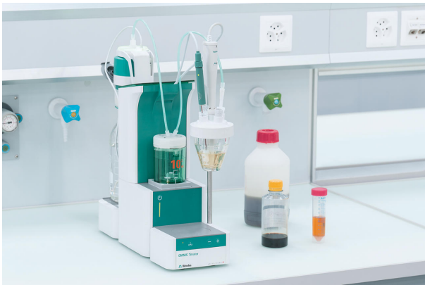
Abbildung 1. OMNIS Titrator mit einer dThermoprobe. Beispielaufbau für die thermometrische Titration von Eisen.
