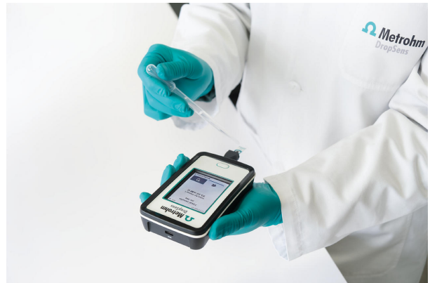
Abbildung 5. Beispiel für einen neuartigen tragbaren Aufbau, bei dem eine miniaturisierte ionenselektive Siebdruckelektrode mit einem tragbaren Potentiostaten für Messungen vor Ort verwendet wird.
