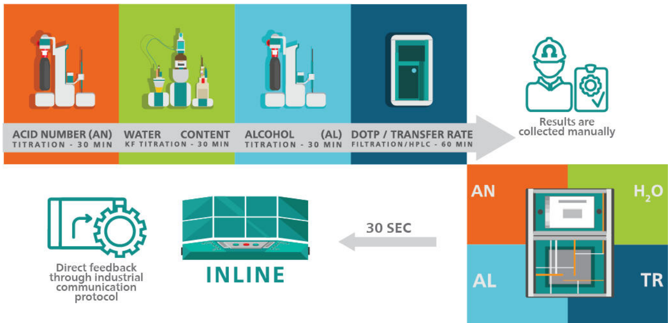
Abbildung 1 Schritte zum Messen wichtiger Parameter in der DOTP-Produktion durch Implementierung von Offline- (oben) oder Inline-Analyseverfahren (unten).
