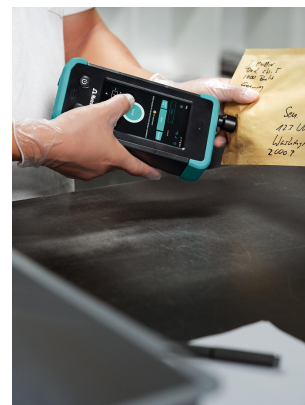
Abbildung 1. Das Auffinden von Schmuggelware - von Fentanyl bis Anthrax - in der Post ist ein sehr reales Problem. Die Fähigkeit von Raman, Papier zu durchleuchten, ist ein unschätzbarer Vorteil.
