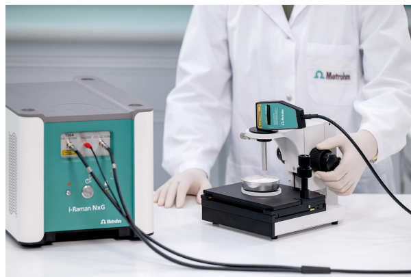
Abbildung 2 In dieser Studie wurden das i-Raman NxG 1064 und eine montierte Glasfasersonde von Metrohm verwendet.
