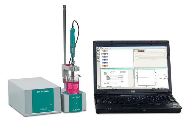
Figure 1. Módulo de pH 867 controlado por el software tiamo para realizar la adición estándar.
