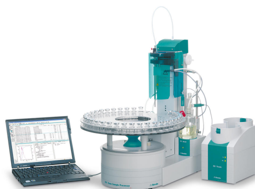
Figure 1. Sistema completamente automatizado que consta de un 874 Oven Sample Processor con 851 Titrando para el Karl Fischer coulombimétrico después de la vaporización de cualquier humedad presente en la muestra.
