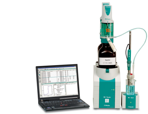
Figura 1. 905 Titrand con tiamo. Configuración de ejemplo para el análisis de litio en salmuera.
