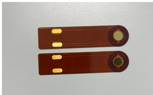
Figura 1. El cristal antes (abajo) y después (arriba) de la deposición.
