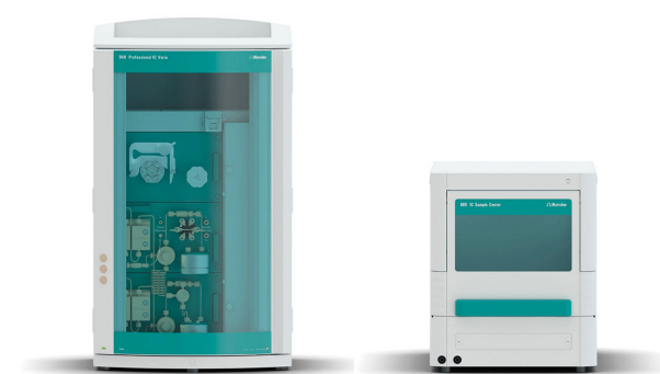
Figura 1 Configuración instrumental que incluye un 940 Professional IC Vario con un gradiente binario de alta presión y detección de conductividad después de la supresión química (L) y un 889 IC Sample Center – cool (R). El enfriamiento puede prolongar la estabilidad de la muestra.
