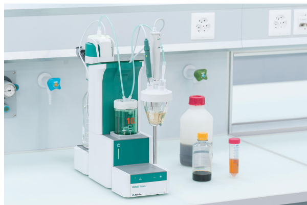
Figure 1. Titulador OMNIS Professional equipado con una sonda térmica y un agitador de varilla.
