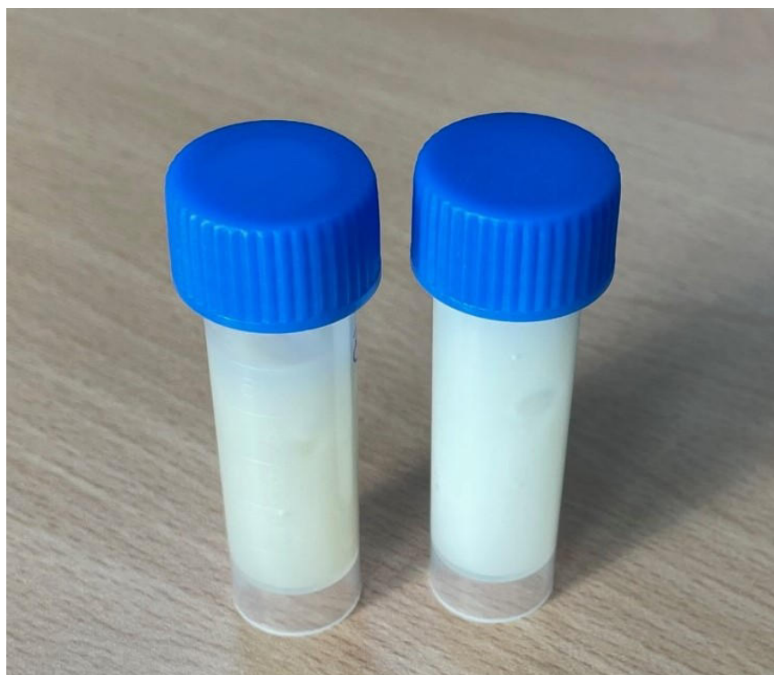
Figure 2. Grasa extraída en frío de embutidos molidos. El éter de petróleo se eliminó a 15 mbar a temperatura ambiente.
