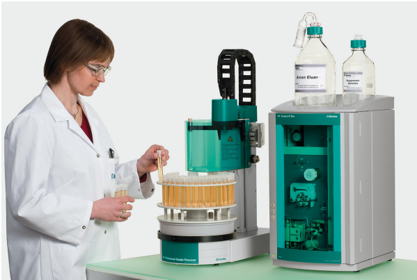
Figure 1. Instrumentación Metrohm IC compacta y fácil de usar para cuantificar oxihaluros, además de aniones estándar, en agua potable.
