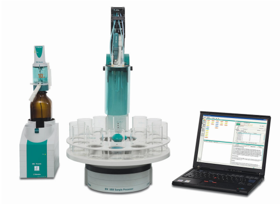
Figure 1. Sistema Titrand compuesto por un cambiador de muestras USB 814 en combinación con un Titrand 907 y tiamo.
