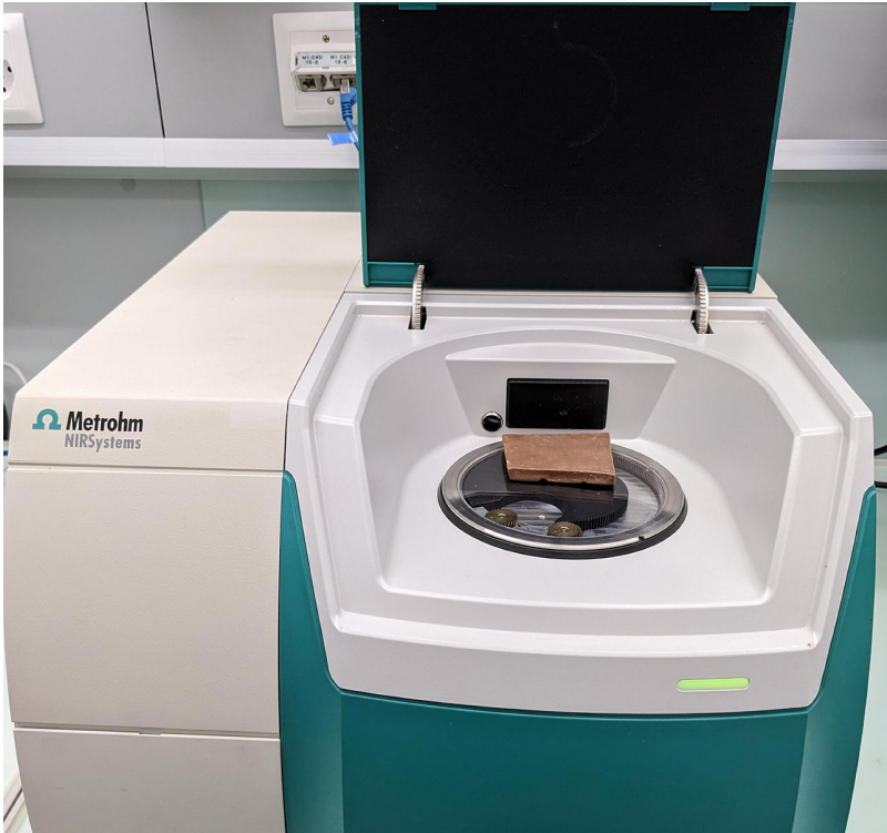
Figure 1. Analizador de sólidos Metrohm NIRS DS2500 con una barra de chocolate que cubre la ventana de muestra.
