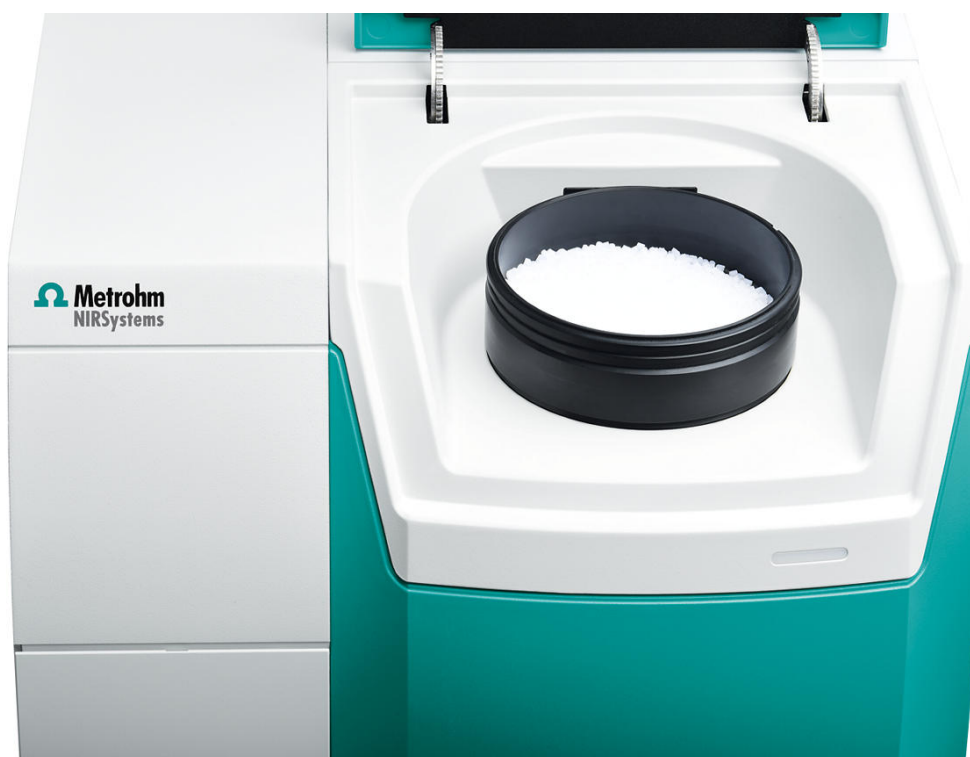
Figure 1. Analizador de sólidos Metrohm DS2500 con el vaso de muestra grande DS2500 para medir la viscosidad intrínseca del tereftalato de polietileno reciclado (rPET).
