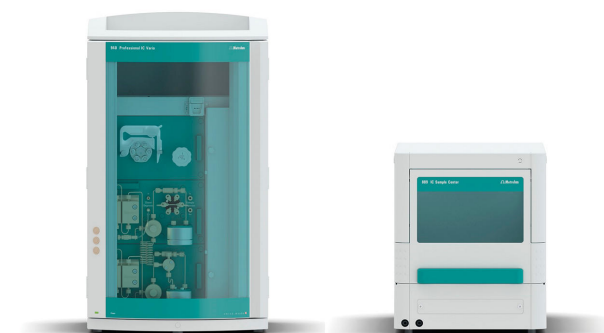
Figure 1 Installation instrumentale comprenant un IC Vario professionnel 940 avec un gradient binaire à haute pression et une détection de conductivité après suppression chimique (L), et un IC Sample Center 889 - froid (R). Le refroidissement permet de prolonger la stabilité de l'échantillon.
