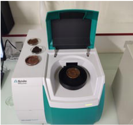
Figure 1. DS2500 Solid Analyzer avec des échantillons de selles humaines.
