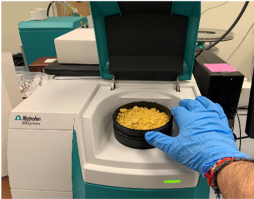
Figure 1. Échantillon de moût de fermentation placé sur l'analyseur de solides DS2500.
