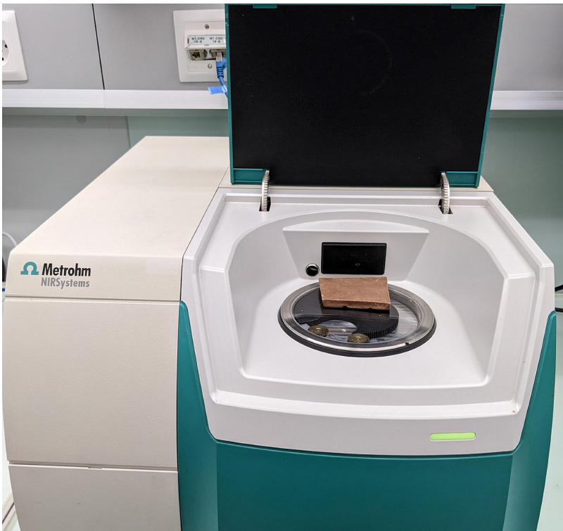
Figure 1. Metrohm NIRS DS2500 Solid Analyzer avec une barre de chocolat couvrant la fenêtre d'échantillonnage.
