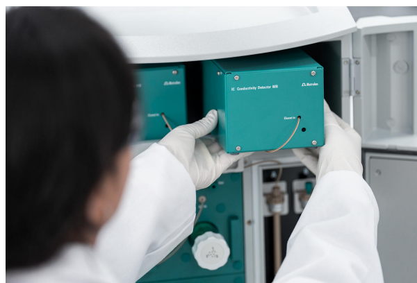
Figure 1. Il rivelatore di conduttività IC MB mostrato qui ha un volume cellulare ridotto ed è inerte nei confronti dell'acido metansolfonico.
