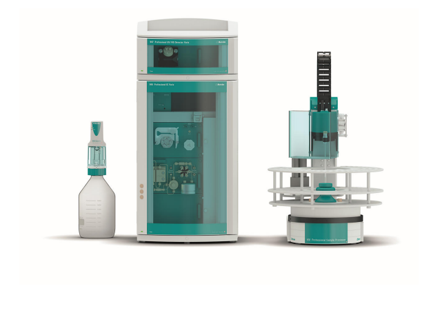
Figure 1. Configurazione strumentale comprendente un 940 Professional IC Vario (al centro), 947 Professional UV/VIS Detector Vario SW (in alto al centro), 858 Professional Sample Processor (a destra) e MiPCT-ME, eseguita con Metrosep A PCC 2 HC/4.0 e un Dosino (a sinistra).
