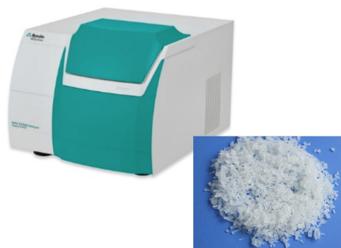
Figure 1. L'analizzatore solido DS2500 è stato utilizzato per raccogliere gli spettri del polimero PVA.
