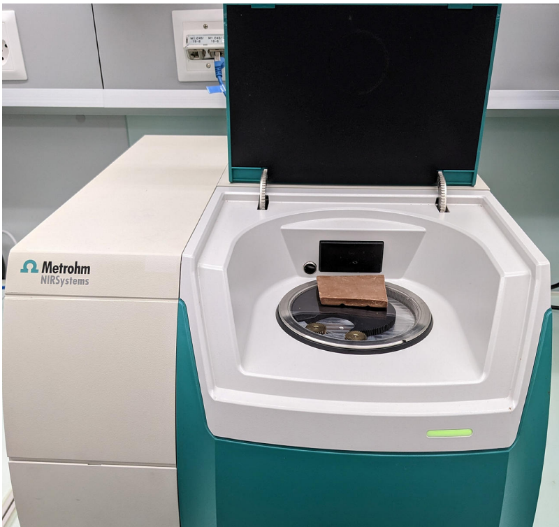
Figure 1. Metrohm NIRS DS2500 Solid Analyzer con una barretta di cioccolato che copre la finestra del campione.
