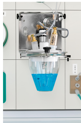
Figure 3. Primo piano della cella elettrochimica in 2060 CVS Process Analyzer.
