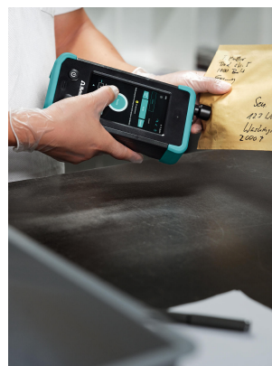
Figure 1. Trovare merci di contrabbando – dal fentanyl all'anthrax—per posta è un problema molto concreto. La capacità del Raman di analizzare la carta è una risorsa inestimabile.
