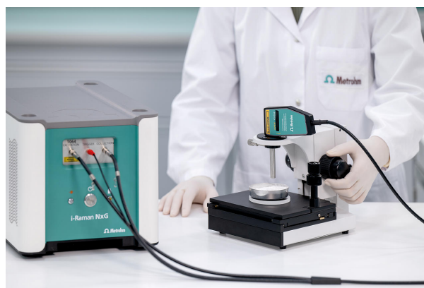
Figure 2. In questo studio sono stati utilizzati lo strumento i-Raman NxG 1064 e la sonda in fibra ottica montata di Metrohm.
