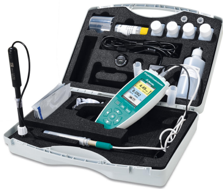
Figure 1. すべての付属品と、淡水流の溶存酸素を測定するた めのO2-Lumitrodeおよび導電率センサーを備えた914 pH / DO /導電率計を含む輸送ケース。
