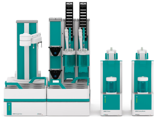
図1. 塩化物含量の測定用に、dProfitrode電極およびdAg-Titrode電極を備えた OMNIS サンプルロボット S、OMNIS ドージングモジュール、OMNIS Advanced タイトレーター
