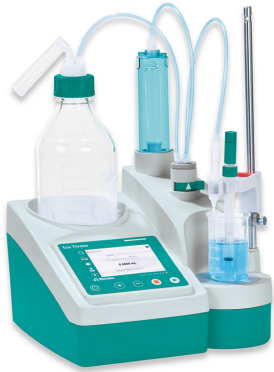
図1. pt1000を備えたUnitrode電極と自動滴定装置Ecoタイトレーター
