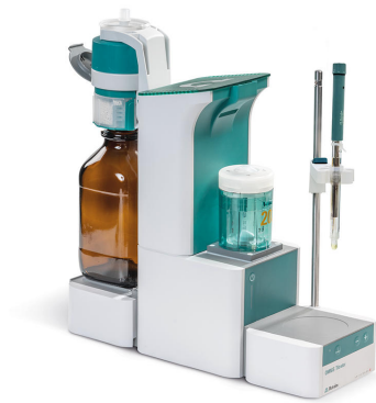
図1. Pt1000内蔵のdUnitrode電極を装備したOMNISプロフェッショナルタイトレーター
