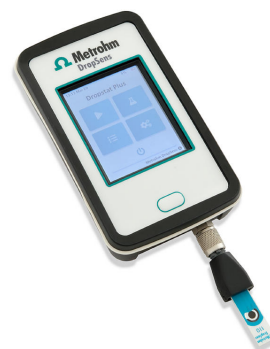
図1. DROPSTATPLUS装置とCASTDIRは、スクリーンプリント電極を接続するために使用されます。
