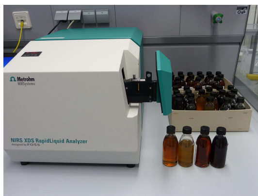
図 1. XDS RLAと137サンプルの測定の様子
